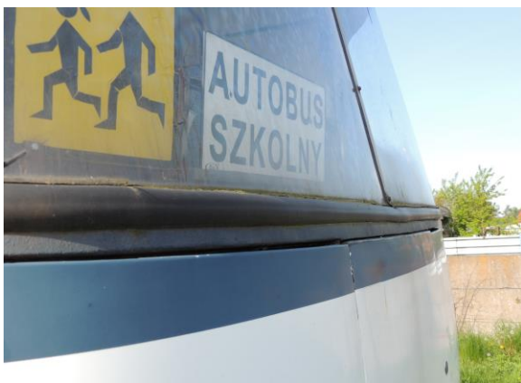
Fot. 21 Uszczelka okna tylnego
